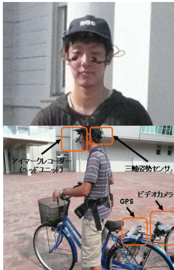
図-1 アイマークレコーダー・実験機材の装着状態
