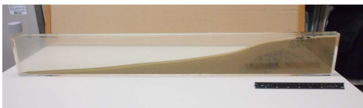
土石流実験水槽(プロトタイプ800mm長)
